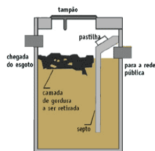
Caixa de Gordura esquema de funcionamento
